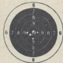
Abbildung 3b: Mit Einstecklauf und Ladelöffel auf 10 m Entfernung.
